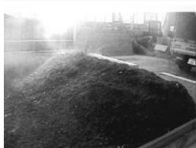
初期醗酵ヤードで約1週間醗酵させレーン式自走醗酵マシンに投入。
