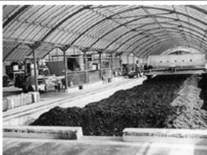
レーン式自走醗酵マシンで、本格的に醗酵させます。温度はほぼ72℃を維持。高温のため、堆肥中の種子やうじ虫・大腸菌・サルモネラ菌などもこの時点で死滅します。
