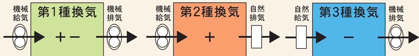
**第1種換気**は、給気と排気に送風機を使用する方式です。換気量が確実に確保でき、室内を**正圧**（室内の圧力の方が高い：+圧）から**負圧**（室内の圧力の方が低い：-圧）まで設定できるので、様々な換気の目的に合わせることができます。
